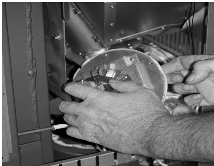
Εικόνα 37: Αφαιρέστε το μοτέρ εξάτμισης και καθαρίστε το
