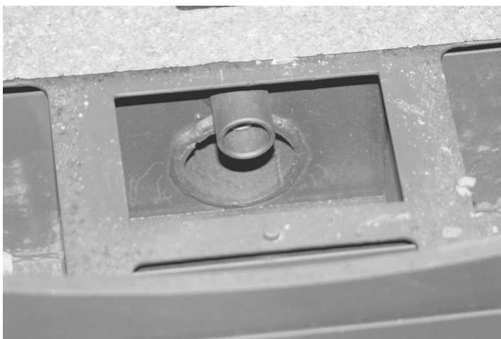
Εικόνα 35: Αφαιρέστε τυχόν στάχτες από το σωλήνα της αντίστασης ανάφλεξης (κάτω από το δοχείο καύσης)
